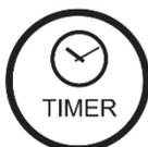
Quando il ventilatore è in modalità standby, utilizzare il pulsante del timer per impostare un intervallo, in segmenti di un'ora, tra 1 e 12 ore dopo il quale il ventilatore si accenderà. Una volta raggiunto il numero di ore desiderato sul display, il numero lampeggerà quattro volte e poi verrà impostato.
