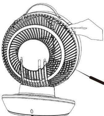
2. Premere le due linguette a sinistra e a destra delle viti e tirare via. Sulla parte anteriore delle pale del ventilatore è presente un tappo di bloccaggio: svitare il tappo in senso orario per rimuovere le pale del ventilatore.
