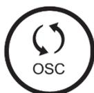
Premere i pulsanti di oscillazione per avviare e arrestare l'oscillazione laterale a sinistra e a destra o verso l'alto e verso il basso. Premere una volta il pulsante per accendere l'oscillazione e premere nuovamente il pulsante per arrestare il movimento: così facendo si può fissare la direzione del ventilatore.
